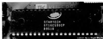
Rajah 2-2: 40-pin Dual Inline Package (DIP) cip adalah variasi daripada National Semiconductor NS16550D UART cip.
