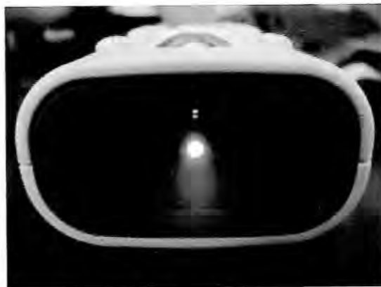
Rajah.1.3: Sinar infrared boleh dilihat menerusi kamera digital.
