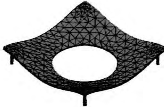
Rajah 4.6: Perubahan struktur bahagian atas alat penunjuk paras kandungan LPG
