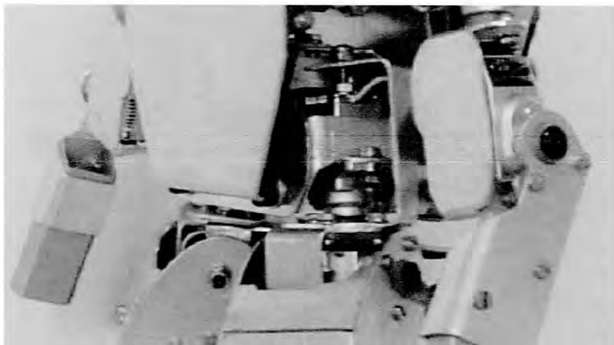
Rajah 2.6: Kedudukan motor pada pangkal peha
