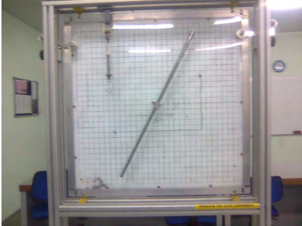
Rajah 2a: Set Radas Eksperimen Keseimbangan Statik – Momen
