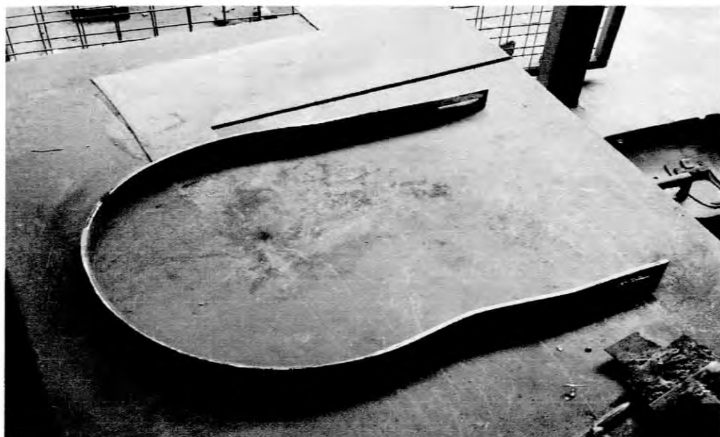
Rajah 1.1: Pemegang bekas serbuk yang berbentuk U atau berbentuk tali pinggang (belt).
