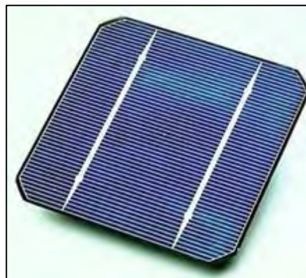
Rajah 2.2 : Sel-sel fotovoltan Menghasilkan Elektrik Secara terus daripada Cahaya matahari
