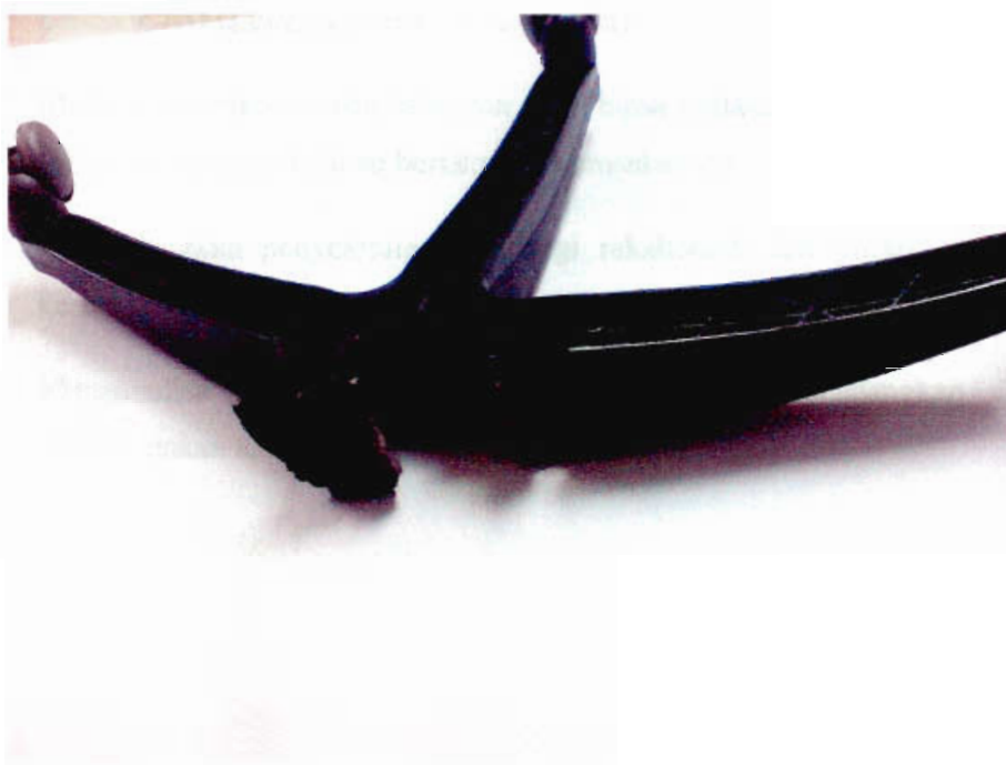
Rajah 1.1 (c): Tapak asas kerusi yang patah pada bahagian “leher”
