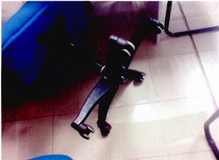
Rajah 1.1 (a): Contoh kerusi eksekutif UTeM rosak menunjukkan tiang tegak kerusi haus dan jerlus ke bawah
