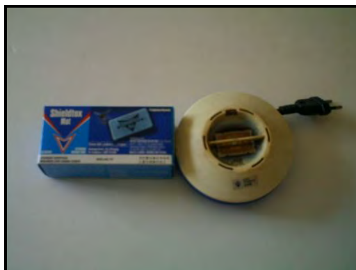
Rajah 3.5: Alat pemanas kepingan elektrik dan kepingan mat
