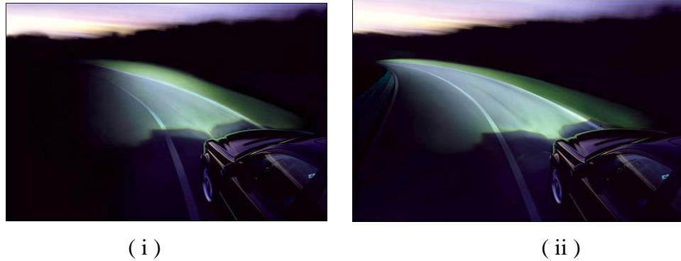
Rajah 2.3: Perbezaan antara kenderaan yang menggunakan lampu utama konvensional ( i ) dan dynamic headlamp cornering ( ii ). (Sumber: http://www.worldcarfans.com/2021107.004/page4/mb-active-cornering-headlamp-system )
