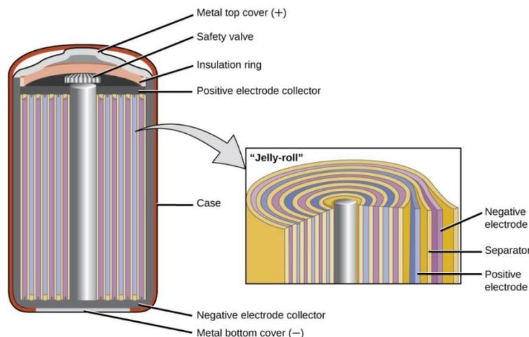
Figure 2.11 : Nickel Cadmium battery[14].
