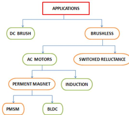
Figure 2.17 : Utilisation selection of motor[27].
