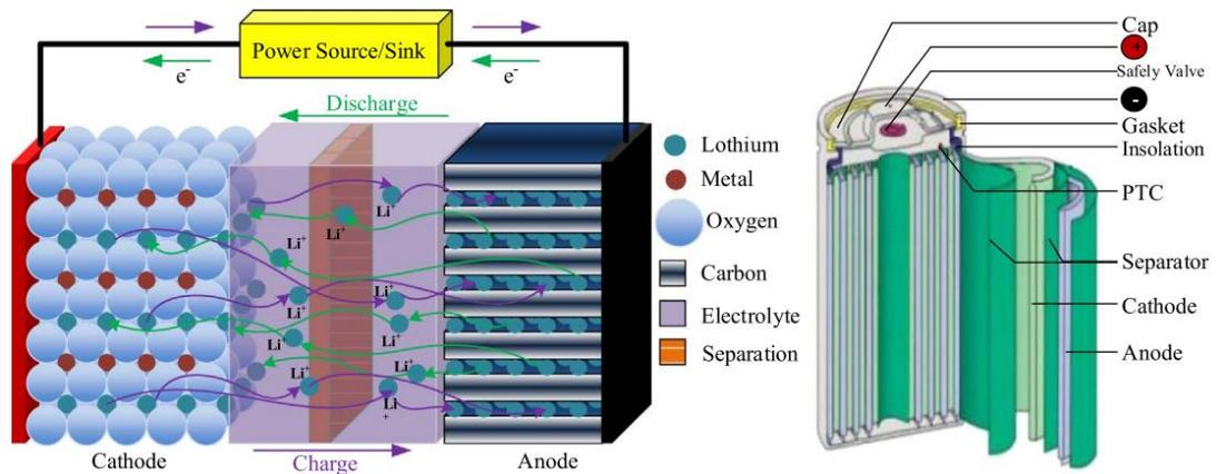
Figure 2.12 : Lithium Ion Battery[10].
