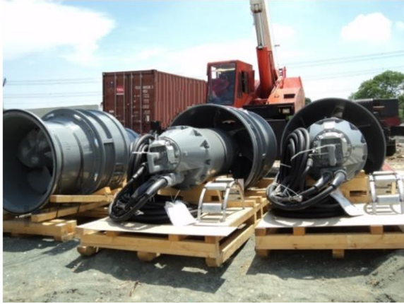
Submersible propeller Flygt PL7121 pumps
