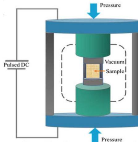
**Figure 2.5.1.3 : Spark Plasma Sintering**
