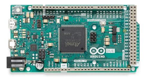
Figure 3-7 - Arduino Due microcontroller
