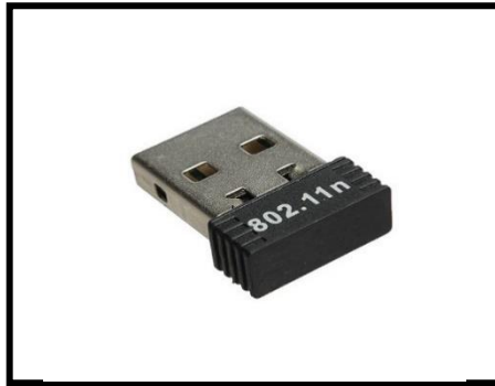
Figure 4.8: Realtek Mini Wifi module
