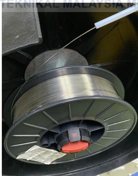
**Figure 3-2 ER308L Si Arc Wire**
