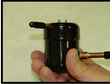
Rajah 2.3: Pemampat Putar Aspen cc (Sumber: Aspen.Inc, 2001).
