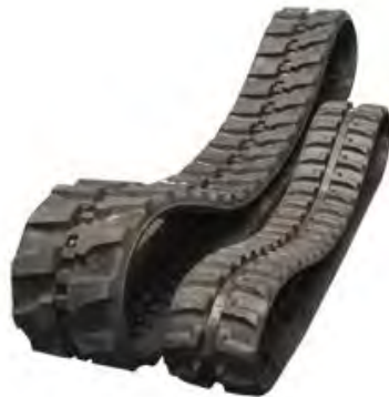
Gambar 2-2 : Contoh ' rubber track ' dan ' steel track '.
