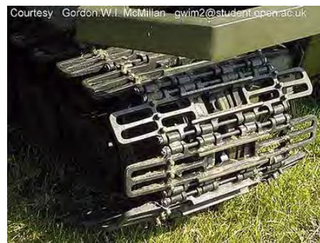
Gambar 2-2 : Contoh ' rubber track ' dan ' steel track '.
