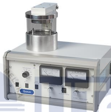
Figure 3.15: SC7620 Mini Sputter Coater machine
