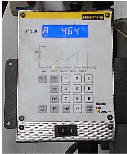
Rajah 3. 9: Alat kawalan relau di mana suhu dan masa sepanjang proses rawatan haba ditetapkan.
