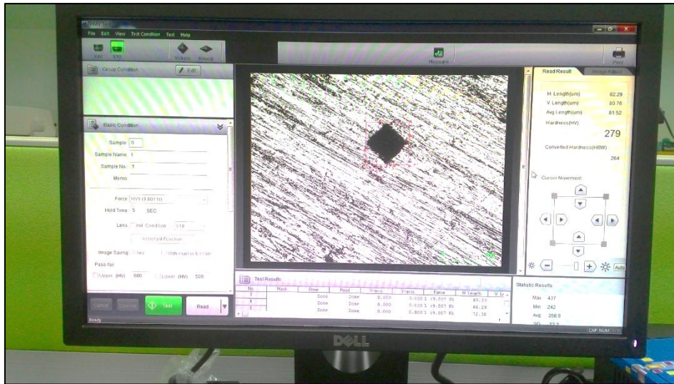
Rajah 3. 27: Tahap kekerasan pada lokasi permukaan yang dikenakan tekanan ditunjukkan pada skrin beserta imej lekukan.
