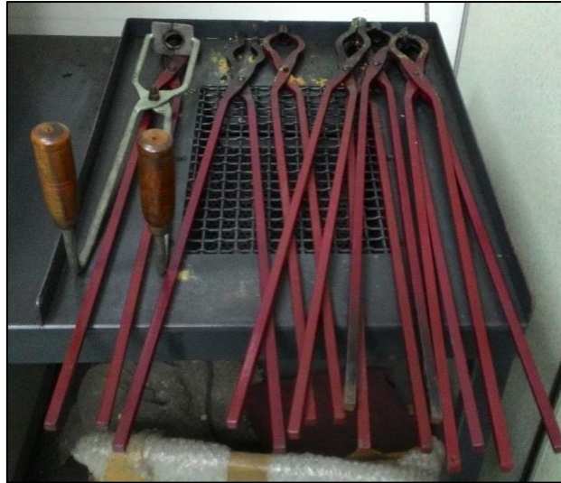
Rajah 3. 7: Alatan untuk mengangkat spesimen pada suhu yang tinggi.
