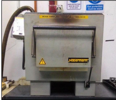
Rajah 3. 4: Relau rawatan haba suhu sederhana yang digunakan.
