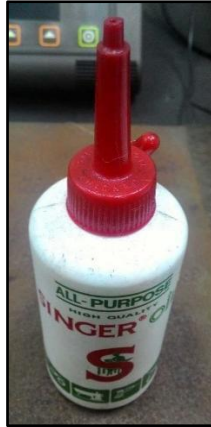
Rajah 3. 15: Minyak motor pelbagai guna sebagai pengganding.
