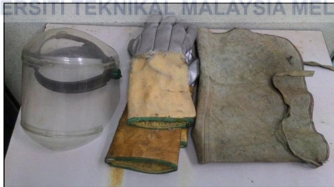
Rajah 3. 6: Kelengkapan keselamatan (PPE) yang digunakan ketika proses rawatan haba dijalankan. Dari kiri, perisai muka, sarung tangan dan apron.
