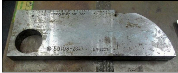
Rajah 3. 13: Blok rujukan V1 dengan ketebalan 25 mm.
