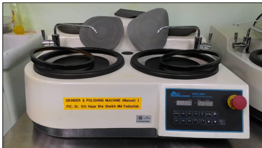
Rajah 3. 18: Mesin pencanai dan penggilap dan kertas canai grit berbeza yang digunakan di dalam kajian ini.
