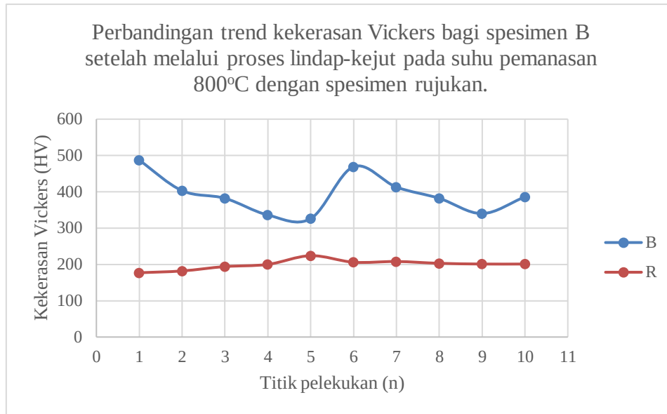
Rajah 4. 8: Trend kekerasan Vickers bagi spesimen B setelah melalui proses rawatan haba lindap-kejut tanpa rawatan pembajaan.
