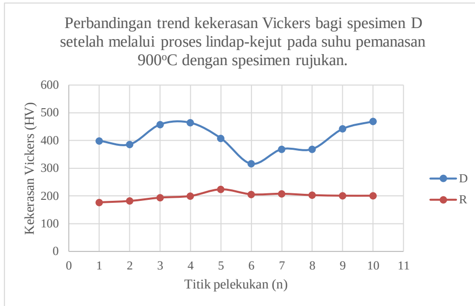
Rajah 4. 10: Trend kekerasan Vickers bagi spesimen D setelah melalui proses rawatan haba lindap-kejut tanpa rawatan pembajaan.
