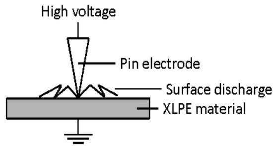
Figure 2.4 : Surface Discharge
