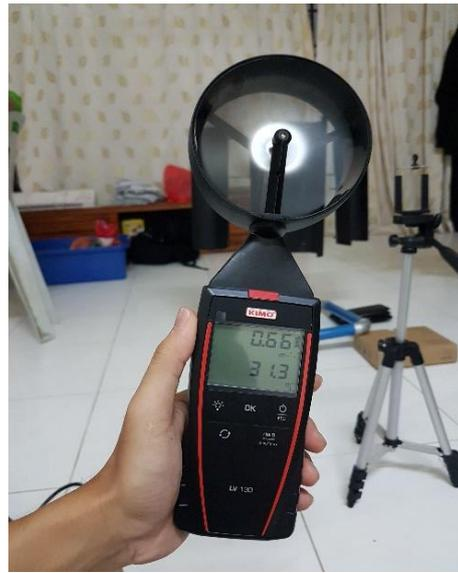
(b) Vane Anemometer
