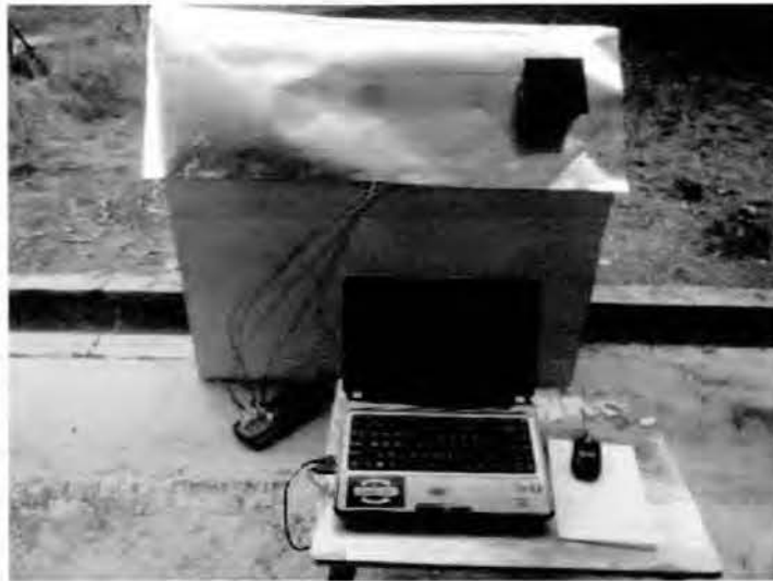
Rajah 3.7 Alatan yang telah siap dipasang untuk mencatat suhu.
