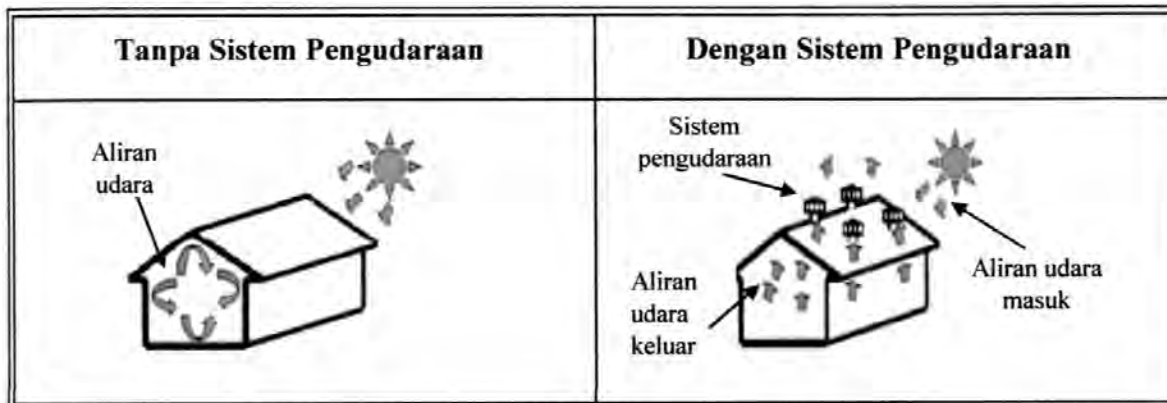
Rajah 2.2 Pergerakan udara sebelum dan selepas memasang sistem pengudaraan di dalam rumah.
