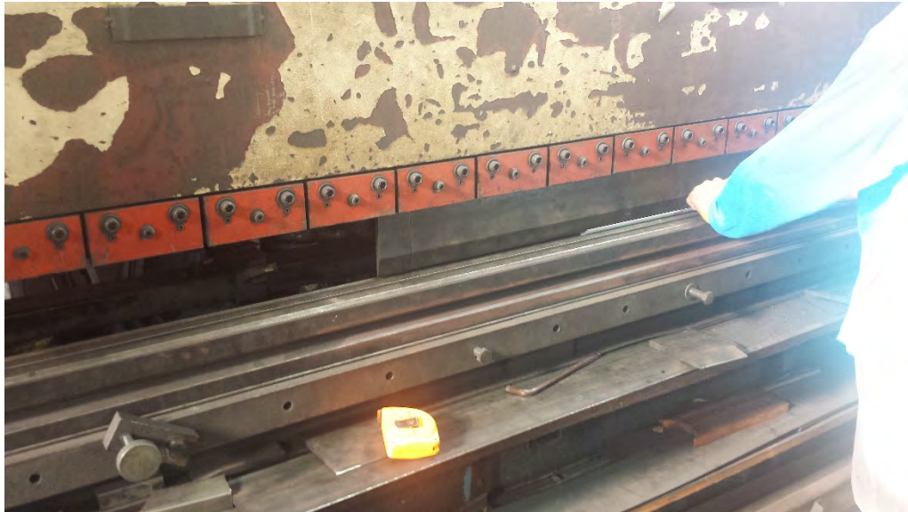
Rajah 4.26 : Kerja Pembengkokkan Plat Menggunakan Mesin Bending
