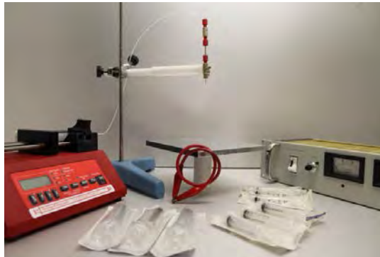
Rajah 1.2 : Mesin Pintalan Elektrik
