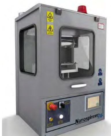
Rajah 2.9 : Pemintal Electric Nanospinner24-XP
